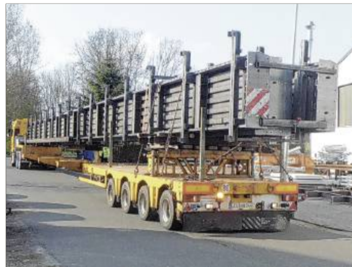
30 Meter lange Stahlform für Betonbinder
