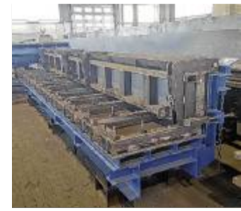
Stahlform für Betonwände
