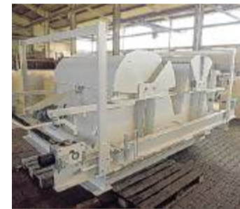
Fahrbare Befüllanlage für die Betonsteinproduktion
